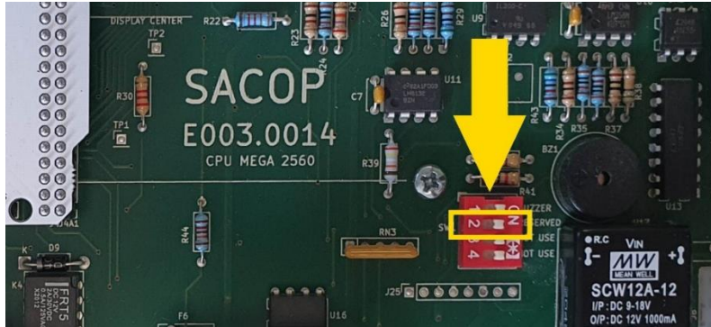
Figura 43 - Dip switch 2 su scheda elettronica CPU E003.0014 (unità Multimaster) per reset PIN installatore
