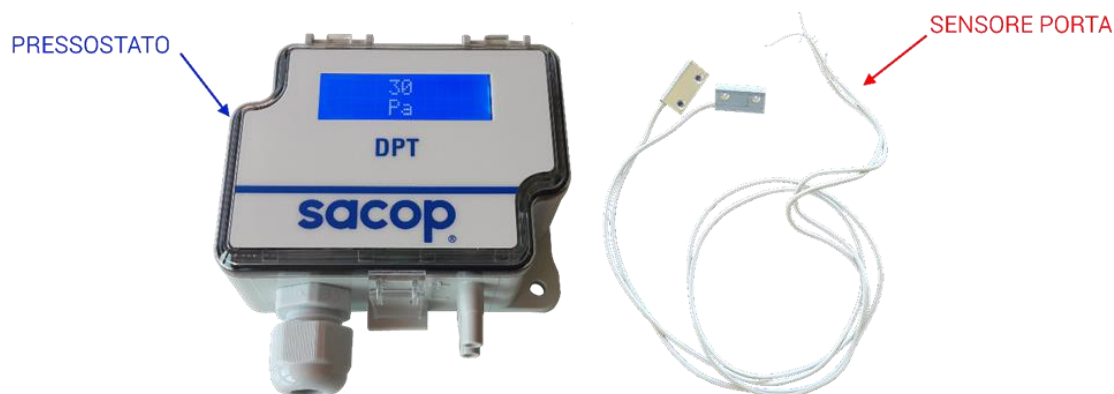
Figura 6 - Kit pressostato differenziale e sensori porta per la gestione automatica della velocità del ventilatore tramite la misura della sovrappressione del locale pressurizzato e della gestione delle fasi di apertura/chiusura delle porte di ingresso e uscita.
