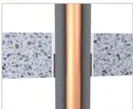
Tubi non combustibili con avvolgimento all'interno del solaio
