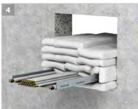
4 Rivestire i cavi nell'apertura per una lunghezza di min. 10 cm con sigillante ROKU® FL e aggiungere o tagliare altri mattoni.
